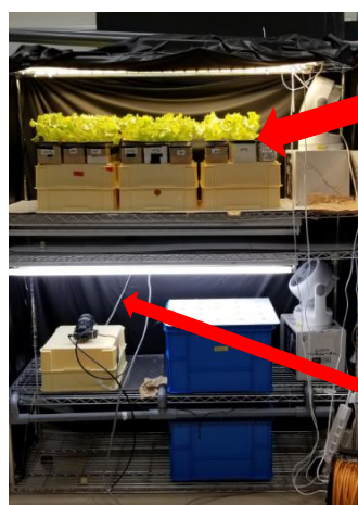
図 1 循環噴霧式 LED 型水耕栽培装置
